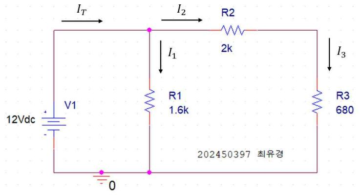
2. 예비 보고서 : 아래 예시와 같이 PSpice 시뮬레이션에 사용한 회로 및 결과가 나타난 사진, 키르히호프 전류 법칙 계산 과정, 계산값(표), PSpice 시뮬레이션 결과(표)
